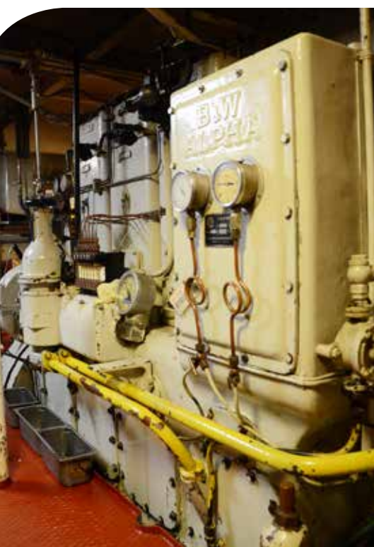
Den tre-cylindrede B&W Alpha diesel med nr. 8511 er absolut ikke lydløs. Også maskinrummet er som en tidslomme fra 1959.
