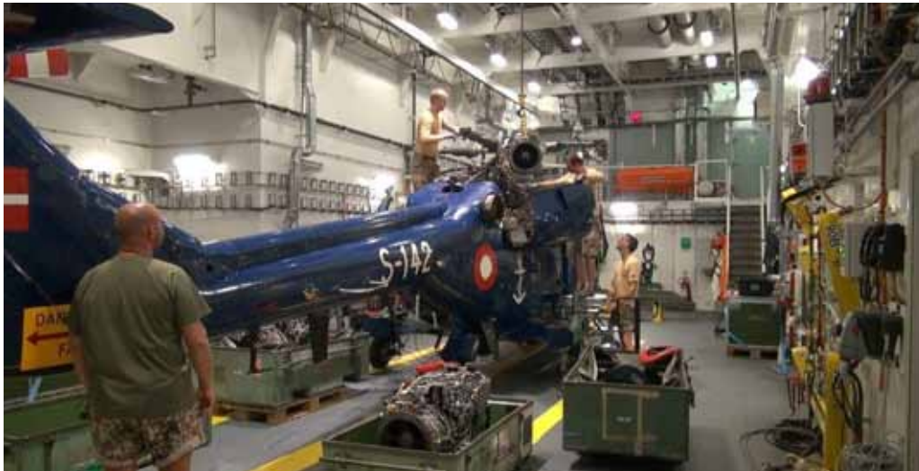
Hastereparation af Lynx'en blev nødvendig efter nødlanding på 'Iver Huitfeldt'. Foto: Søværnet
